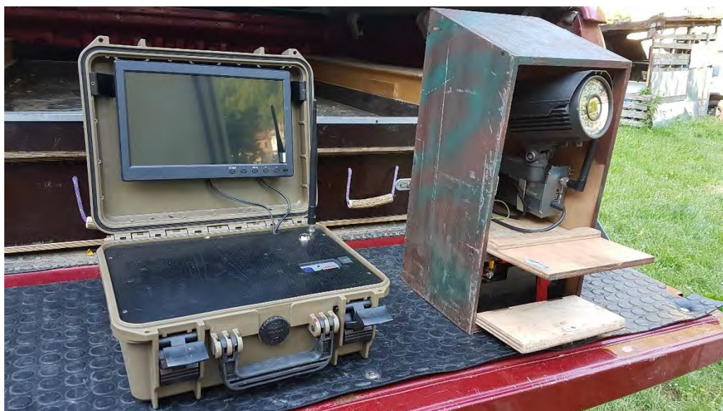
Figura 8.4: sistema di trasmissione immagini da remoto WIFI dotato di illuminatore IR con portata di circa 3 km in campo aperto (Materiali D.R.E.Am. Italia, foto Nicoloso)
