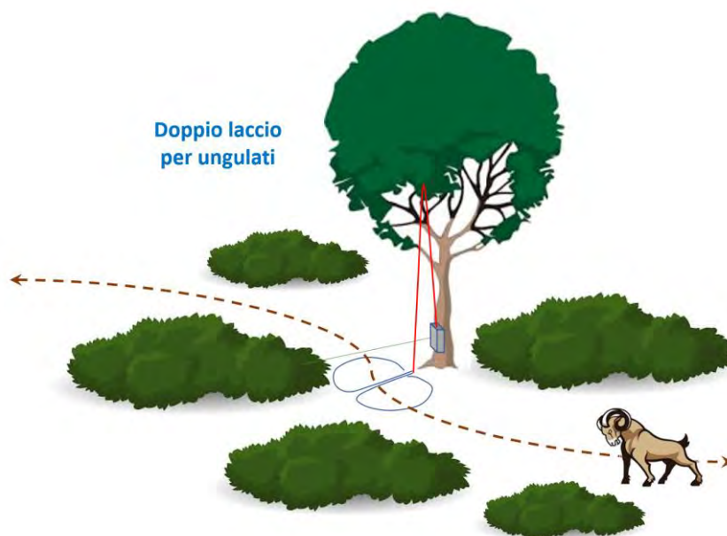
Figura 8.9: schema di laccio per la cattura di ungulati (schema: Nicoloso)
