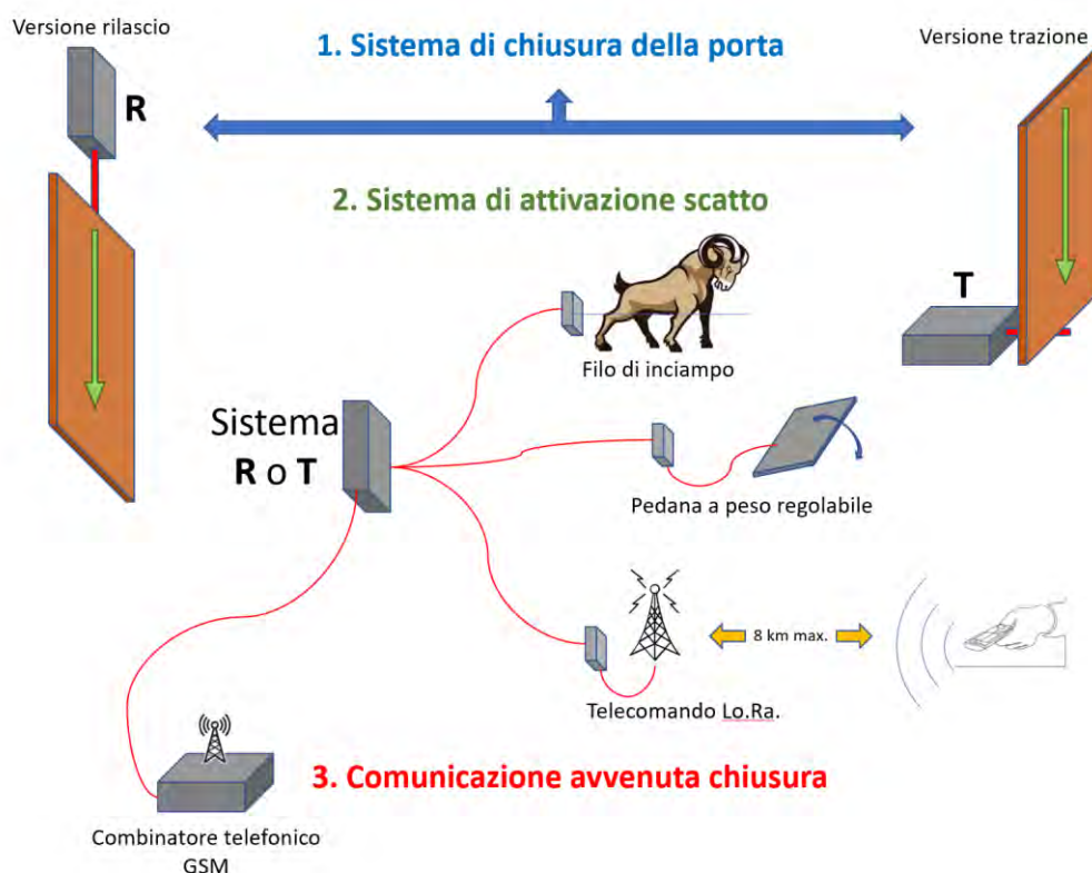
Figura 8.5: schema delle possibili combinazioni dei sistemi di chiusura delle porte delle trappole
