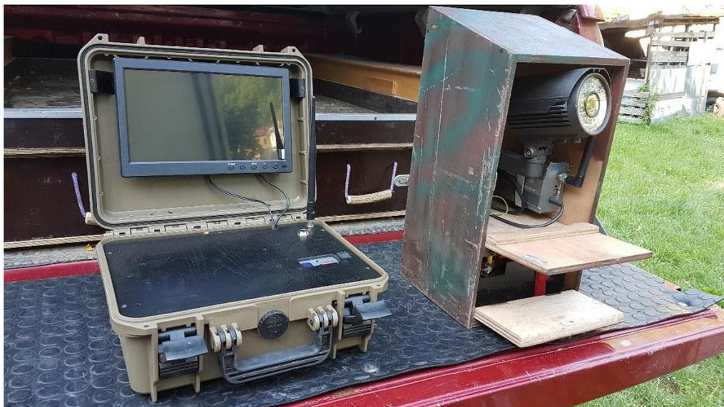
**Figura 8.4:** sistema di trasmissione immagini da remoto WIFI dotato di illuminatore IR con portata di circa 3 km in campo aperto (Materiali D.R.E.Am. Italia, foto Nicoloso)
