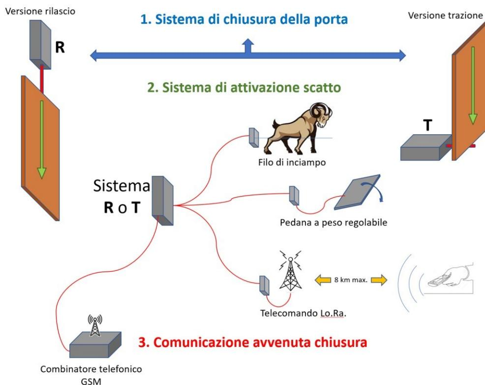
**Figura 8.5:** schema delle possibili combinazioni dei sistemi di chiusura delle porte delle trappole
